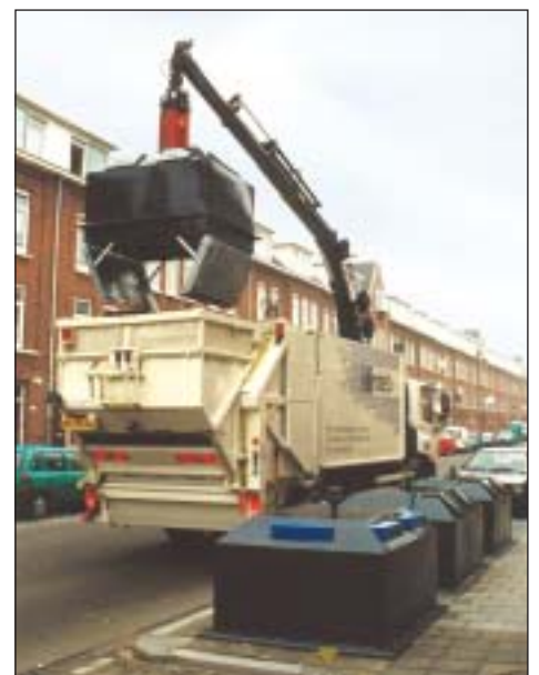
GTC-Entleerung über Bodenklappen
