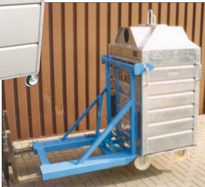
Gabelstapler-Zusatzgerät für Transport und Entleerung
