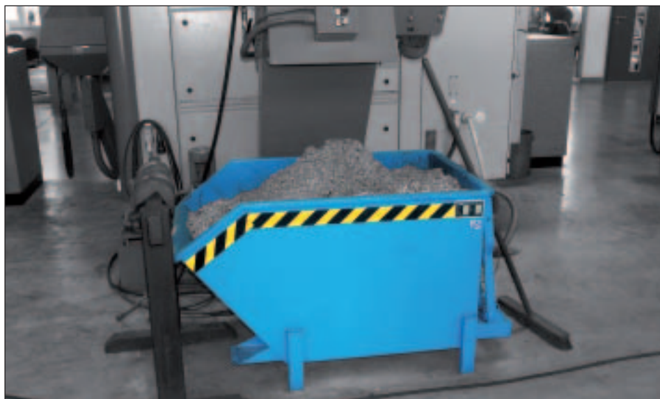
Typ SGU mit Stützfüßen für Hubwagentransport
