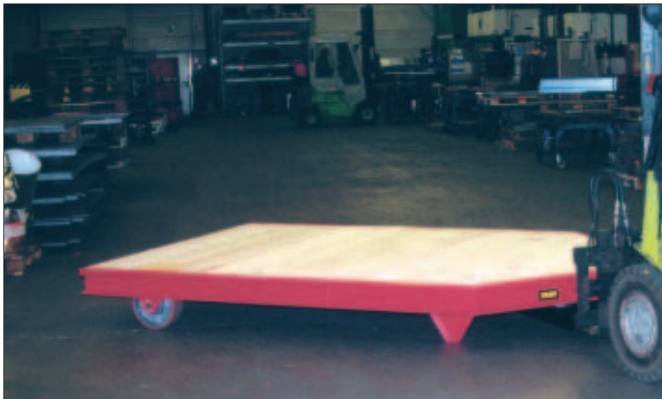
Mit den Gabelzinken in die Einfahrtaschen fahren, anheben und das STS ist betriebsbereit
