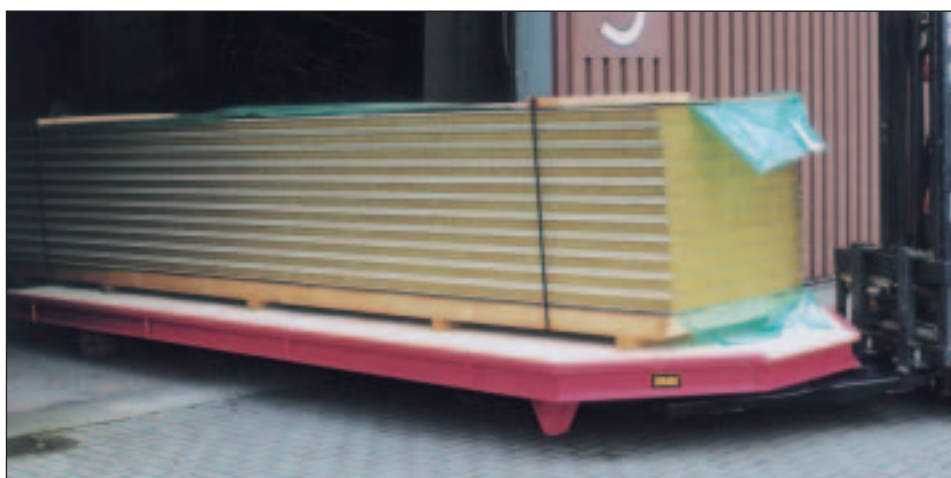
Transport von Langgütern; kleiner Wendekreis durch Direktaufnahme
