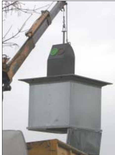
Entleerung über Bodenklappen
