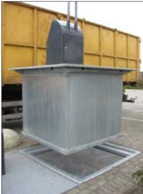
Beim Herausziehen des Containers sichert eine mechanische, selbsttätige Plattform die Grube
